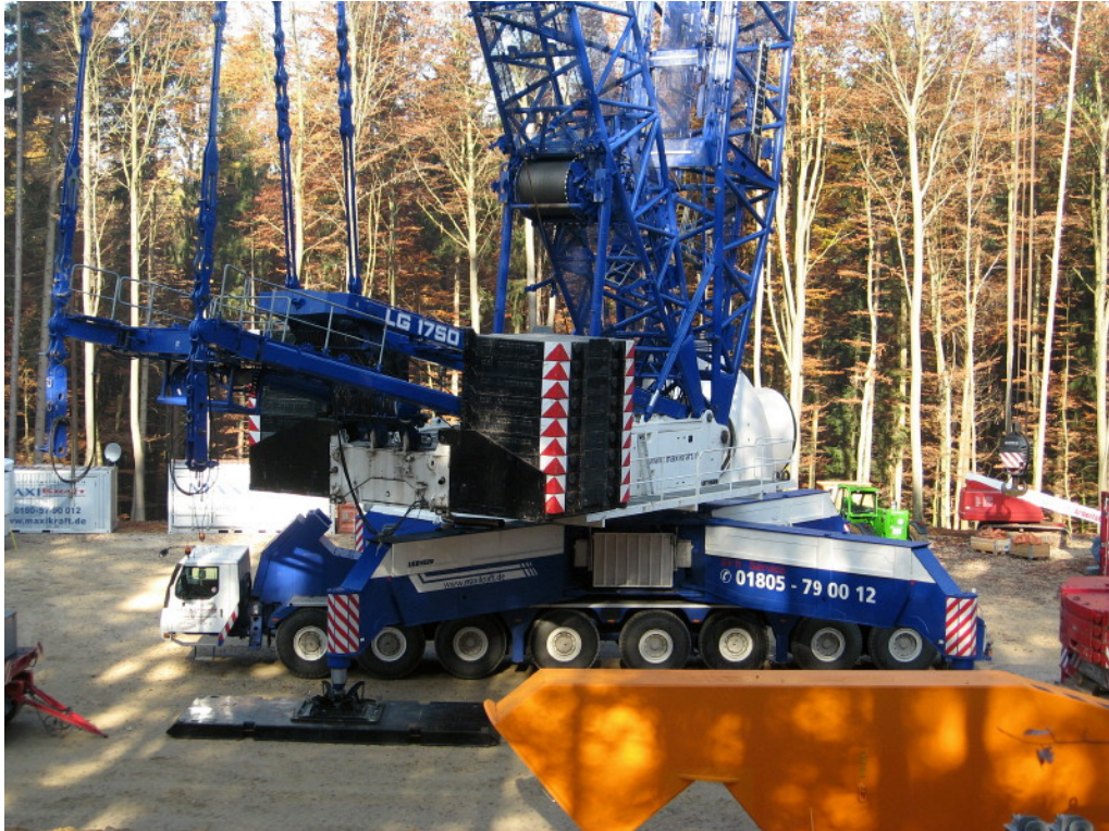
Abb. 5 Kran zum Aufbau einer WEA im Wald
